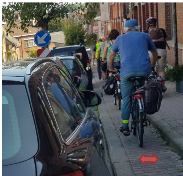
Chaussée d'Hondzocht : cheminement cyclo-piéton disposant d'une largeur insuffisante et absence de zone tampon avec les voitures garées (risque d'emportierage)
