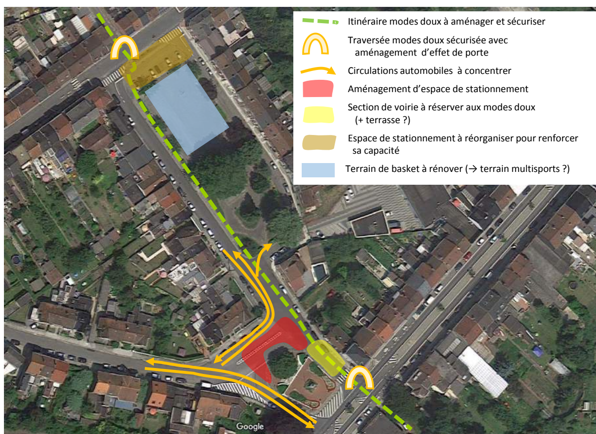
Figure 4 : Propositions d'aménagement de la place du Remblai
